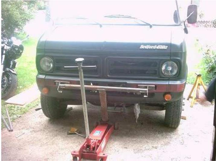
Hilfsmittel hab ich mir nur eines basteln müssen, wegen der fehlenden Hebebühne. Und zwar ist es ein Rahmen, der an den Löchern für die Stoßstange befestigt wird, um die Karosserie wieder auf die Vorderachse herablassen zu können.
