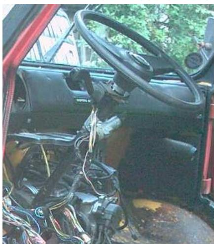
Zum Schluß habe ich das Zündschloß des Omega passend für die Lenksäule vom Bedford gemacht. Nach dem Drehen des Schlüssels sollte er eigentlich anspringen. Wenn der Motor läuft, alle Leitungen dicht sind und noch alles einmal auf seinen ordentlichen Sitz hin überprüft wurde und alle Schrauben fest sind, kann einer Probefahrt nichts mehr im Wege stehen.
