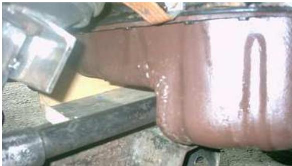
Ich versetzte zuerst den Sitz der Ölablaßschraube nach vorne mit samt der Wölbung. Anschließend wurde die Wanne mit 1mm Blech wie auf dem Foto umgeschweißt. Eigentlich ist es egal, wie man es macht, hauptsache man hält die Maße einigermaßen ein damit die Ölwanne einen sicheren Abstand zur Lenkung hat und die
