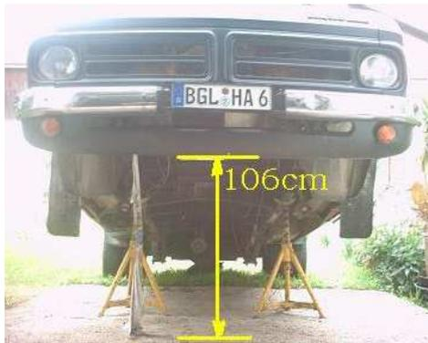
Der Wagen wird nun an der Vorderachse in die richtige Höhe gebracht und die Unterstellböcke am Fahrzeugrahmen angesetzt. Es empfiehlt sich, sie hinter die Aufnahme der Getriebeaufhängung anzusetzen, da sie da sicheren Halt haben.
