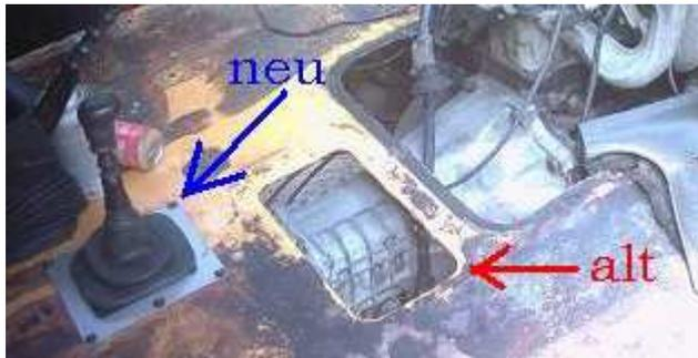
Als Schaltkonsole habe ich einfach den alten Gummibalg vom Omega zurechtgeschnitten, mir einen Rahmen aus Alu ausgesägt und den Gummi damit ans Bodenblech geschraubt. So ist alles schön dicht.
